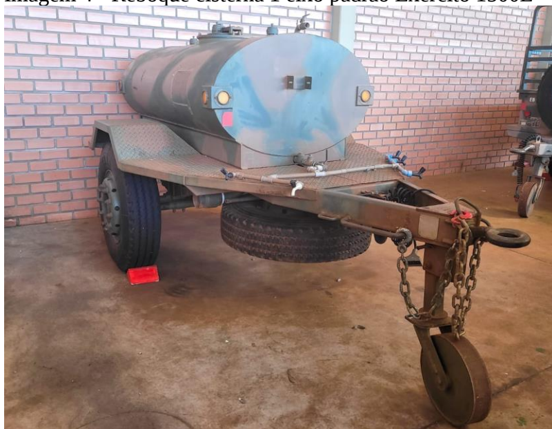
Imagem 4 - Reboque cisterna 1 eixo padrão Exército 1500L
